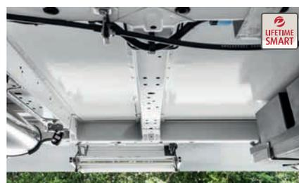
» Holzfreie, verrottungssichere Life time-Smart Aufbaukonstruktion (GFK-verkleidet) mit isoliertem und beheiztem Wassertank
